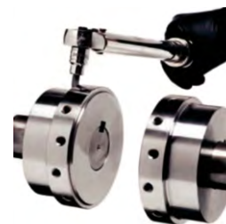
KROK 1 – montaż piast
